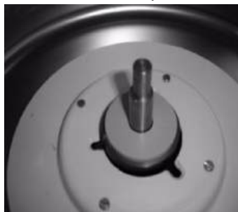
Eje del motor y cámara
