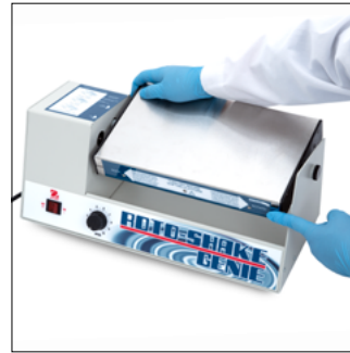
6. Für Rotation drücken Sie die Freigabetaste und bewegen Sie die Plattform nach rechts. Lassen Sie die Freigabetaste los. Wenn die Plattform die richtige Position erreicht, erfolgt die Verriegelung
