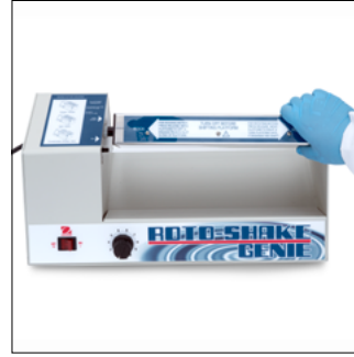
3. Richten Sie die Plattform (mit dem Hinweisschild rechts nach oben) mit der Sechskantwelle am Gehäuse aus und schieben Sie sie auf die Sechskantwelle
