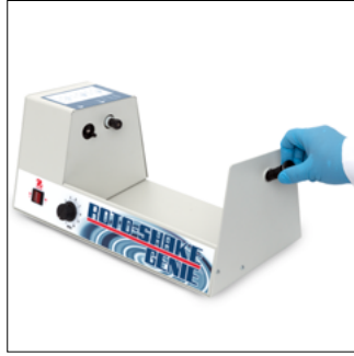
2. Schrauben Sie die Verriegelungswelle heraus und entfernen Sie sie vom Gehäuse
