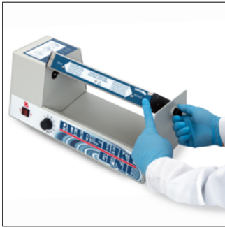
4. Halten Sie die Entriegelungstaste gedrückt und schieben Sie die Verriegelungswelle durch das Gehäuse in die Plattform. Ziehen Sie die Verriegelungswelle vollständig per Hand an und lassen Sie dann die Entriegelungstaste los
